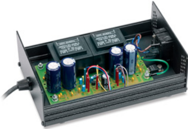
Die Stromversorgung des Einstein ist kanal- respektive phasengetreunt aufgebaut
